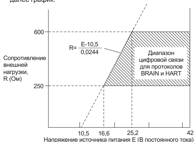
Рисунок 2. Взаимосвязь между напряжением источника питания и сопротивлением внешней нагрузки
